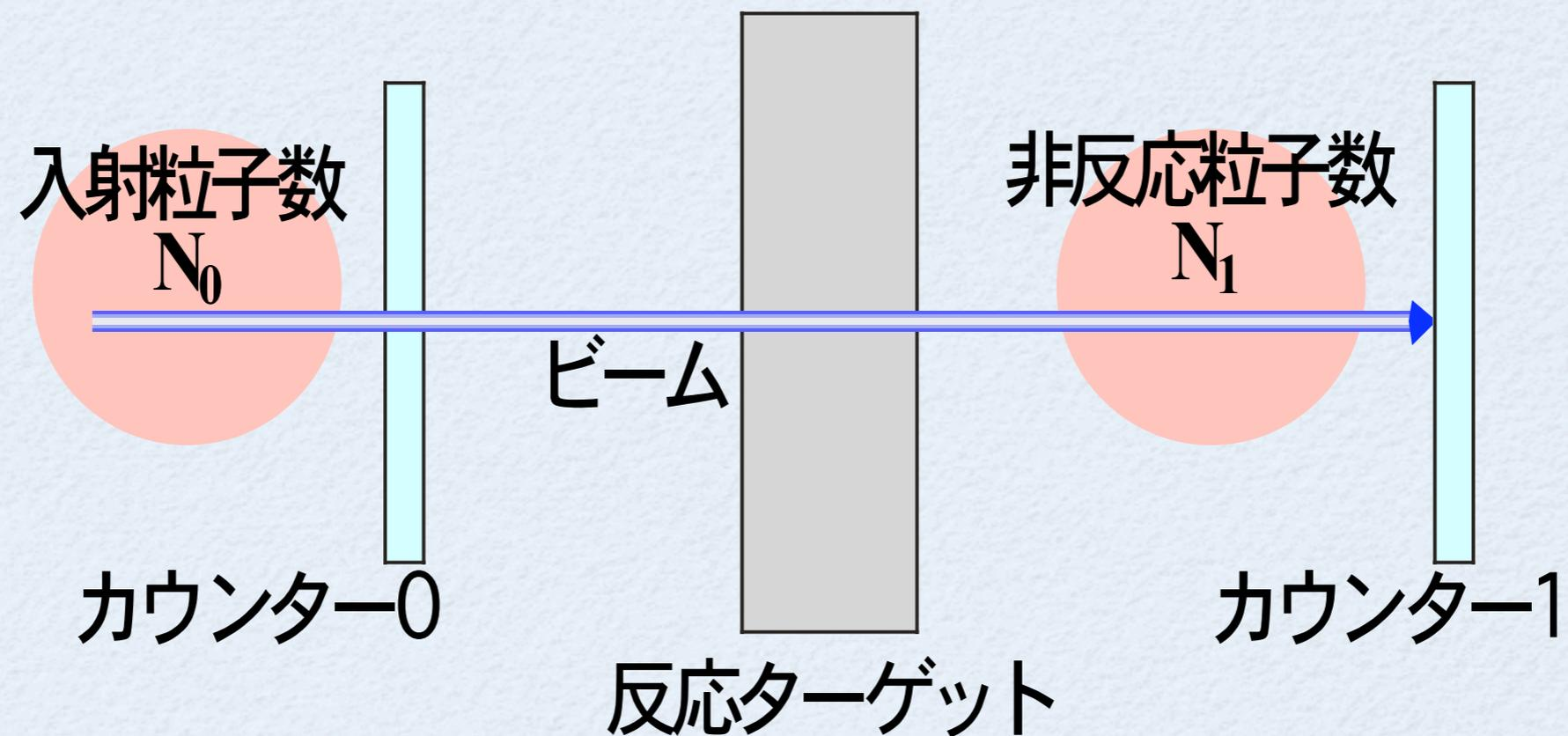
$$\sigma_R = -\frac{1}{t} \ln \left( \frac{N_1}{N_0} \right) \quad t : \text{反応ターゲットの厚さ}$$
