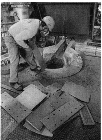
鉄工所の電気炉に投げ込まれる東海発電所で使われた金属廃材。東海村村松で、清野崇宏撮影
