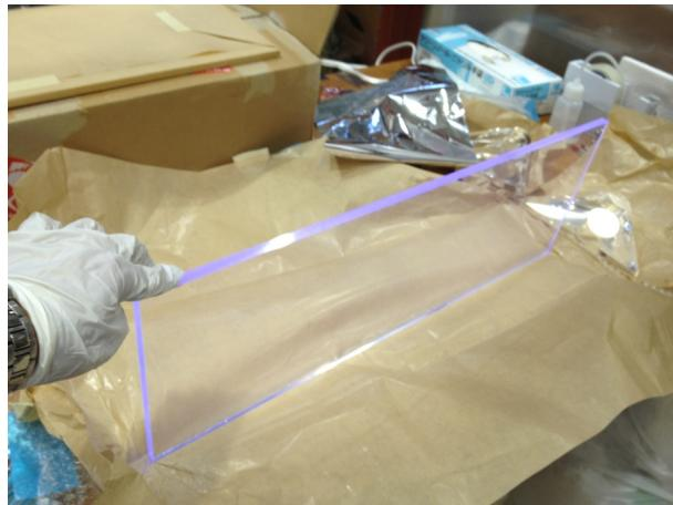
図3.10:  $600 \times 210 \times 10\text{mm}^3$  プラスチックシンチレータの写真
