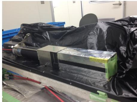
図 3.6: 7cm 角 CsI 結晶の光量測定
