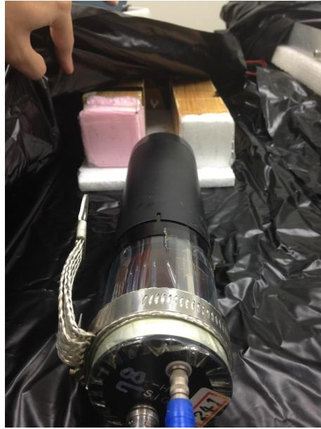
図 3.17: PMT のゲイン測定。PMT が置かれた場所の奥に青色 LED が設置されている。
