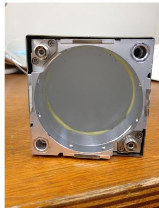
図 3.4: PMT 接続面とフランジ
