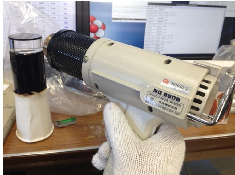
図 3.16: ヒートガンを用いた、プラスチックシンチレータ用のPMTの紫外フィルターの剥がし方
