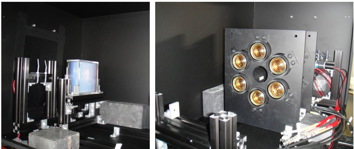
図3.1 エアロゲルを用いたときの検出器配置。エアロゲルは透明なアクリル容器にいれ、PMTの表面から距離を測って設置した。上流、下流には大きさの異なるトリガー用検出器を置き、荷電粒子が検出器の中心を通る事象を選別した。左の写真は輻射体であるエアロゲルを下流側から見た場合で、ビーム粒子は写真左側からエアロゲルに入射する。右の写真は6個のPMTで構成した検出器である。左手前から右奥方向にビーム粒子が通過し、輻射体を通過した際に放射されるチェレンコフ光を検出する。検出器の中心にはビーム粒子が通過するための貫通穴を開けている。
