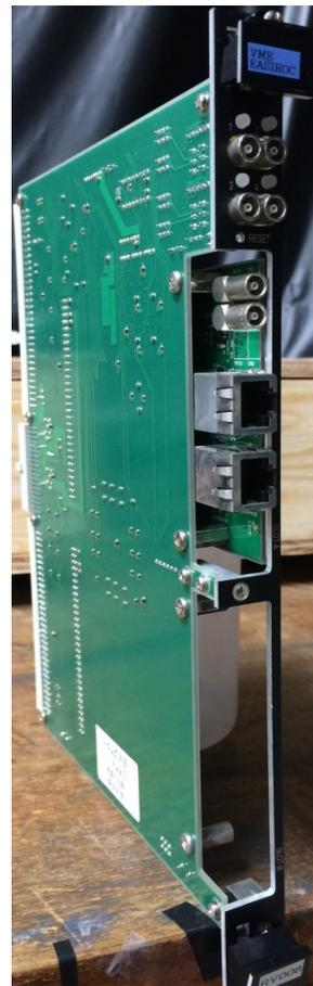
図 2.15 Receiver Module の写真。このモジュールを KEK VME クレートに挿入することで、MTM からの信号をクレート内の全モジュールに対して配布する。
