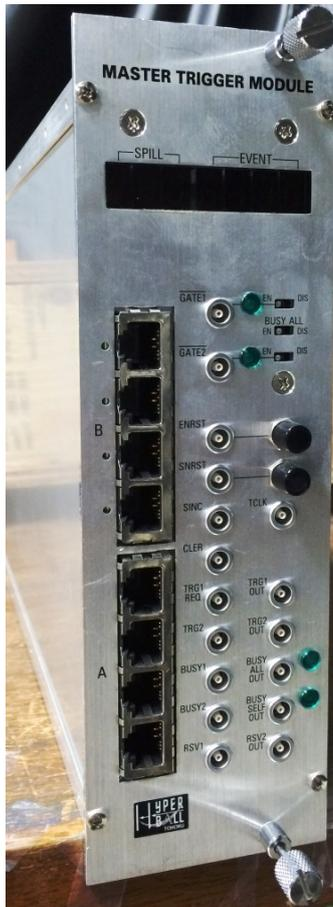
図 2.14 Master Trigger Module の写真。2本の LAN ケーブルによって最大 4 系統の Receiver Module に対してトリガー情報を送信する。また、Busy 信号の管理もこのモジュールが行う。
