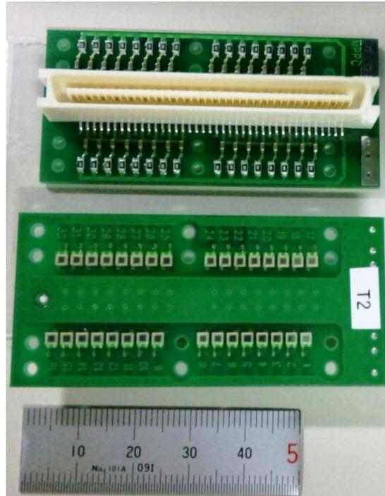
図 2.2 MPPC 基板の写真。1 mm × 1 mm の MPPC を 32 個配置した。
