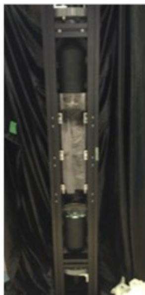
図 6.1 接着の様子。アクリルと PMT の接着は片面ずつ行った。
