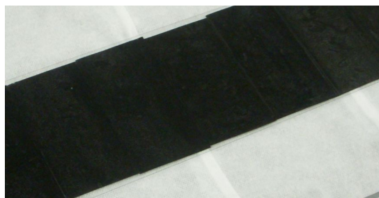
図 3.3: ガラスに貼られた電極用のカーボンテープ
