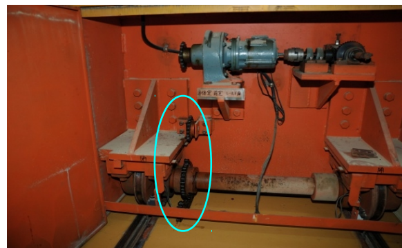
駆動用チェーンの破断
