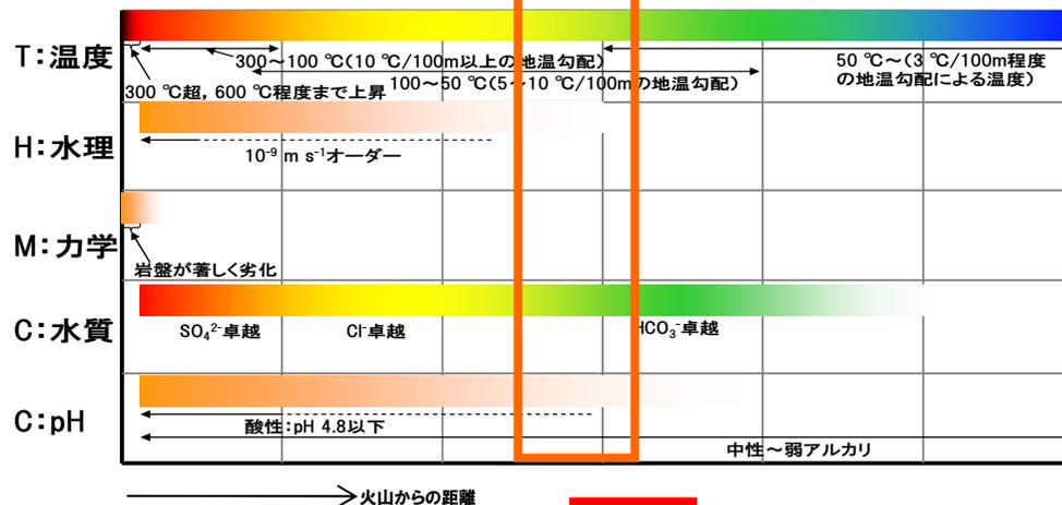
Step4, 5: THMCの変化と処分システムの性能に係るパラメータの変化との関係の検討へ
