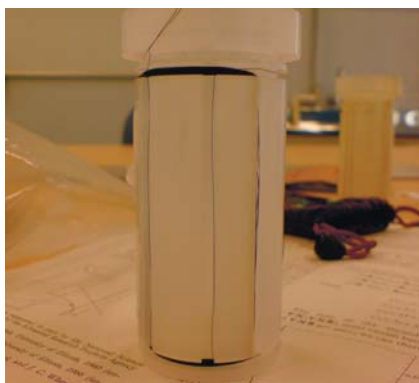
図 4.5: NMR コイルと Kel-F チューブ台座
