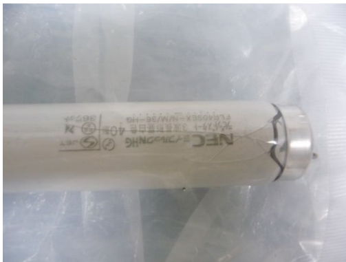
蛍光管内は負圧なので端を割って空気を入れる(強めにたたく)
