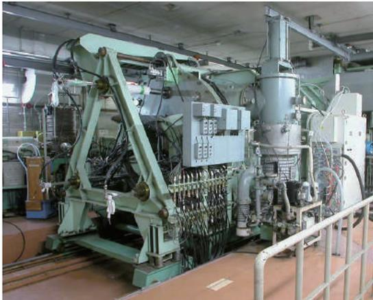
AVFサイクロトロン。陽子を80MeV（80メガ電子ボルト。光速の40%程度）まで加速できる。AVFはAzimuthally Varying Fieldの頭文字。磁場をビームの軌道に沿って（つまり方位角方向に）変化させることにより鉛直方向の集束作用を持たせるための工夫で、ビーム強度を減らさないように効率よく加速できる。
