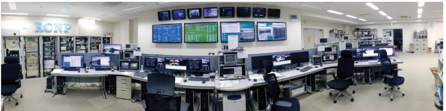
加速器を運転する制御卓（コンソール）。加速器やビームラインの装置類の大半を遠隔制御する中核部で、オペレータが24時間働いている。
