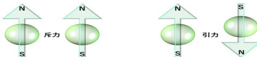
図 1.1 2核子が並行に並び、スピンの向きが同じ場合は、互いに隣接する極性は等しくなるため、2核子間で働く力は斥力となる。その一方、スピンの向きが異なる場合は、互いに隣接する極性は反対になるため、2核子間で働く力は引力となる。
