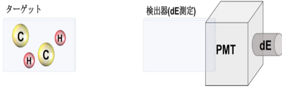
図 2.2 左図:ターゲットとしての機能. 右図:検出器としての機能.
