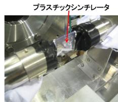
図 2.9: プラスチックシンチレータ。左上がビームの上流。実験終了後にアルミナイズドマイラーを破いた状態。
