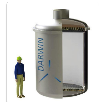
DARWIN Total Xe: 50 ton Target: 40 ton Fiducial: 30 ton Limit: \sim 10^{-49}
