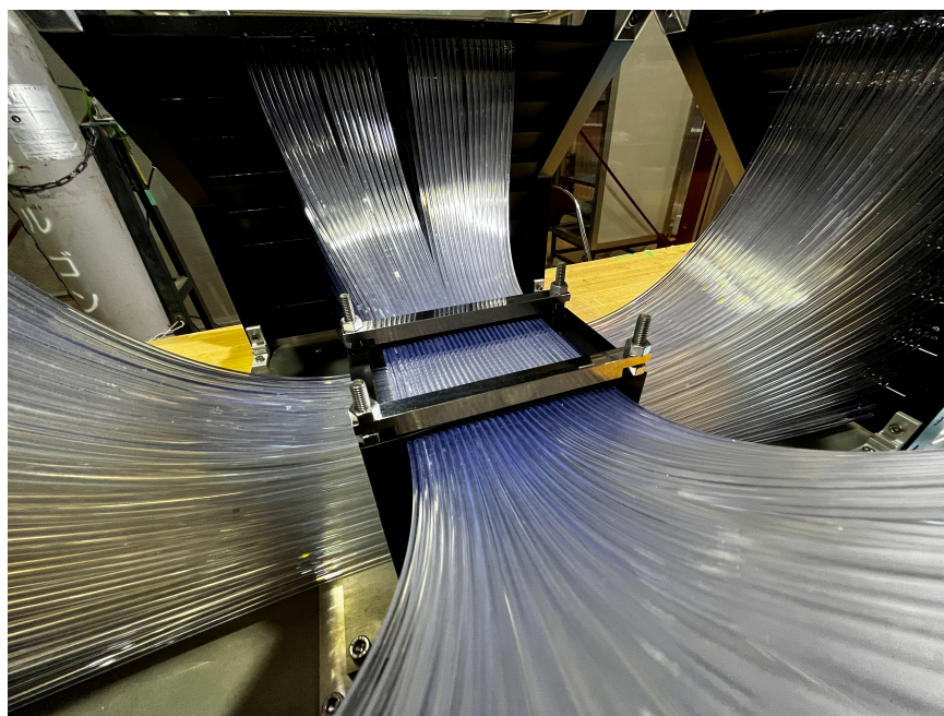
図 2.5: AFT の標的部分 写真上部から下部に向かってビームが通過する.
