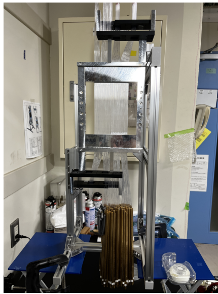
(a) ファイバーガイドフレームとファイ (b) ファイバーを一本ずつおもりをつる (c) テンションをかけたまま、ファイ バーをエポキシ樹脂で接着している写真 しテンションをかけている写真 バーをフレームに固定している写真
