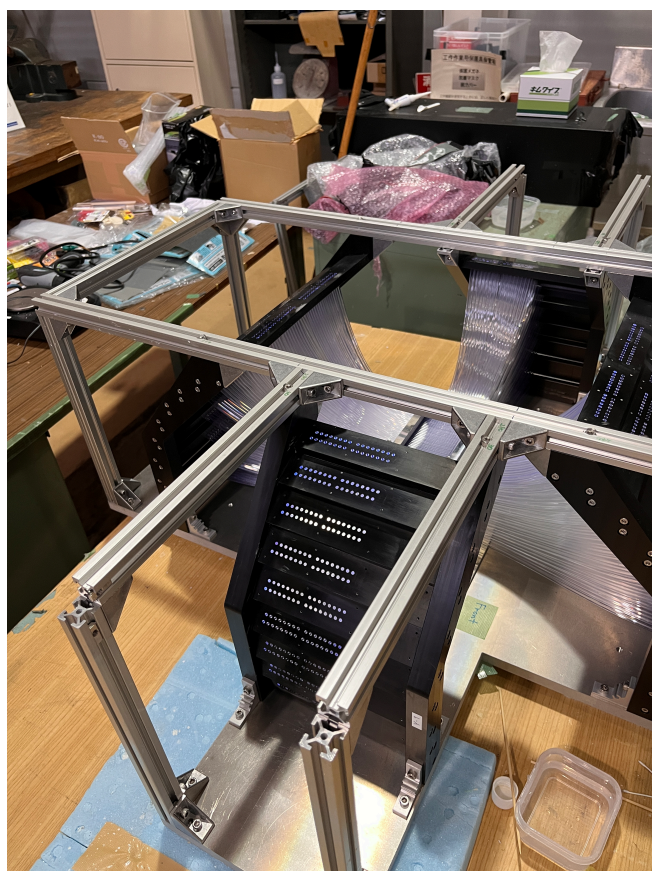
図 2.4: AFT 全体の写真 各ファイバーの両端は読出しのため黒アクリル部に固定されている.
