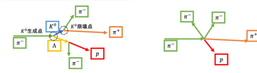
図 2.3: K^0 生成反応と主なバックグラウンドとなる multi \pi production
