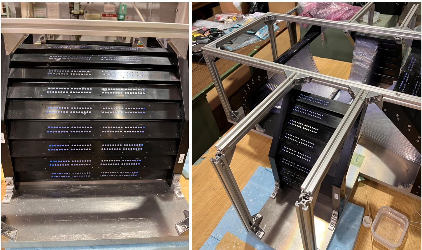
図 3.5: すべての読出し面の研磨が終了した AFT
