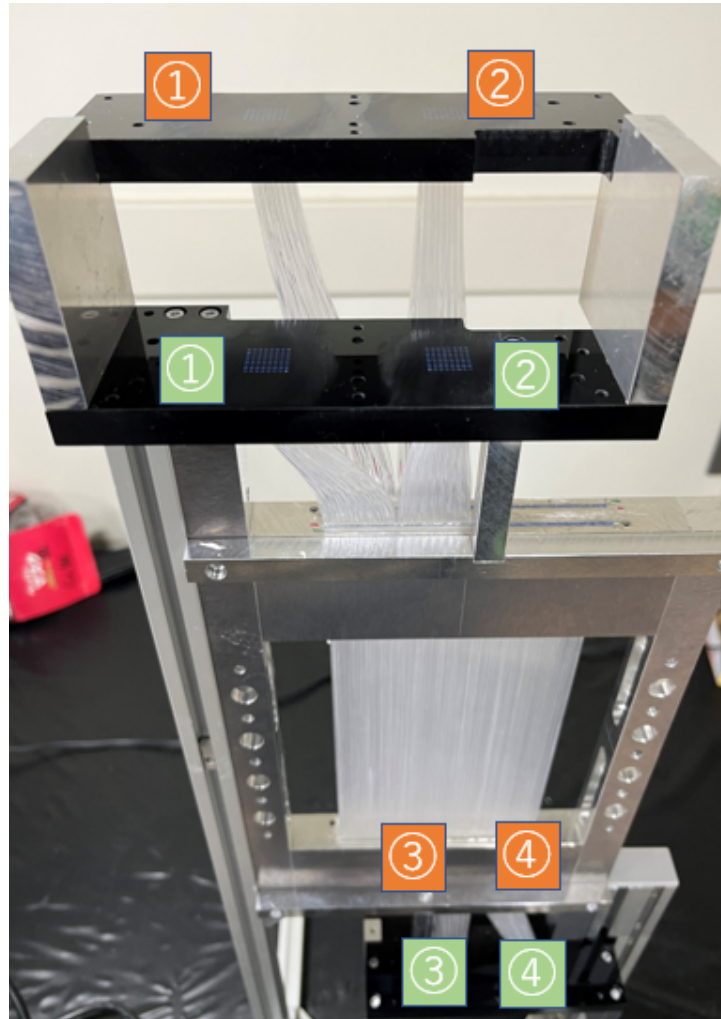
図 8.4: UU' 層の MPPC 位置のアサイン
