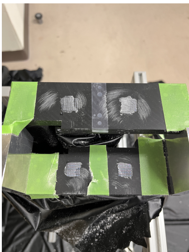
図 3.9: 読出し面を紙やすりで研磨していく時の様子
