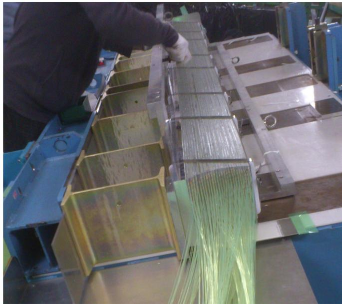
図 5.9: 積層したシンチレータと鉛板をステンレスのバンドで縛ってモジュール化した様子。
