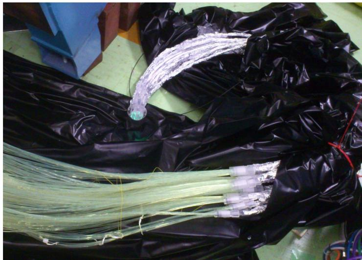
図 5.12: 下流側にのびたすべての波長変換ファイバーをポリマーライトガイドに接続した様子。
