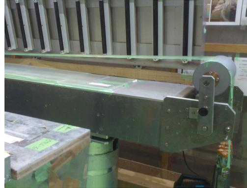
図 5.7: 接着剤の塗布に用いた自動ステーションとディスペンサー。
