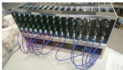
(c) IKDBOX の背面の写真。下部で振り分けた電源及び信号線を各ボードに振り分けている。
