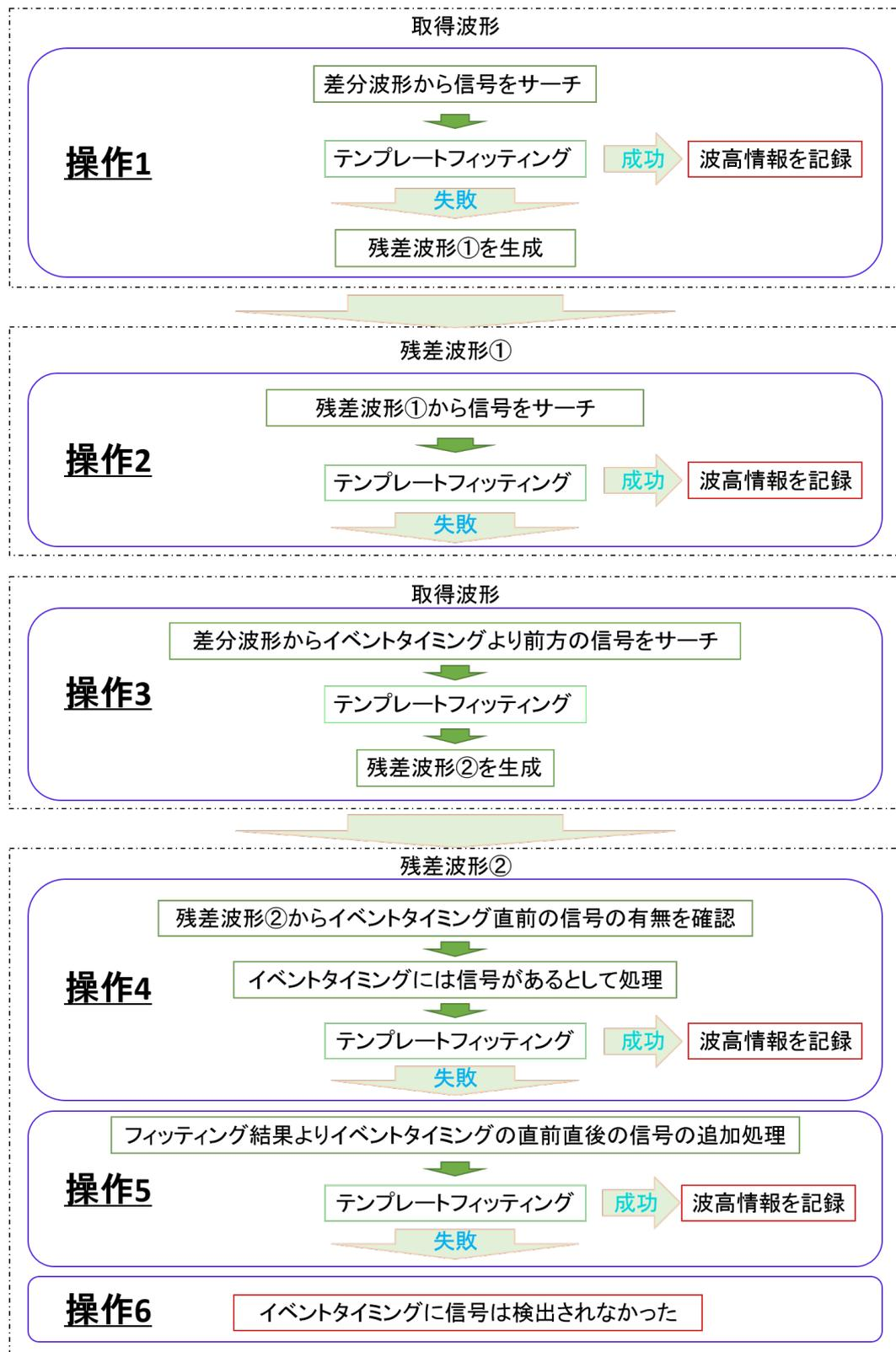
図 3.2: 波形解析のチャート図。イベントタイミングの信号の波高が正しく読まれたと判断するまで、最大 4 回のフィッティングを試みている。それぞれの操作については本文中で説明する。
