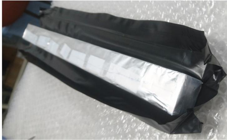
図 5.4: BGO 結晶を覆う反射材と遮光材。アルミフォイルで包んだ BGO 結晶を PMT を取り付ける面と反対からみた写真。アルミフォイルはメンディングテープで止め、ブラックシートも同じ面でブラックテープで止めて包んでいる。
