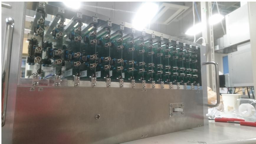
(a) IKDBOX の前面の写真。上部に回路ボードを並べている、下部の端子は左側がスイッチング信号の入力で、右側が電源である。
