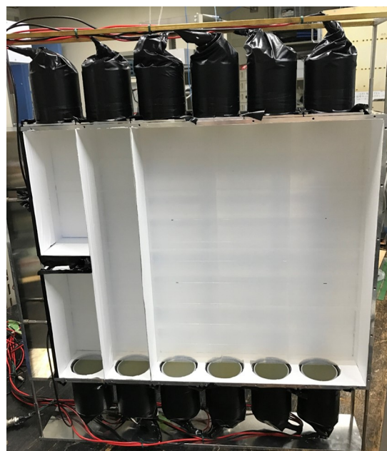
図 5.4: エアロゲルを入れた AC 検出器実機の内部：この写真はビーム下流側の面を取り外して撮影した。エアロゲルはナイロン糸により倒れることなく固定されている。
