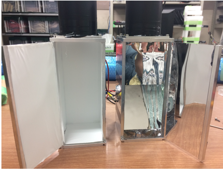
図 4.5: エアロゲルを入れる前の試作機の写真：右の試作機が鏡面反射材を用いた AC1、左の試作機が乱反射材を用いた AC2 である。この写真のようにビーム上流側の面が開くためエアロゲルの入れ替えが容易に行える。
