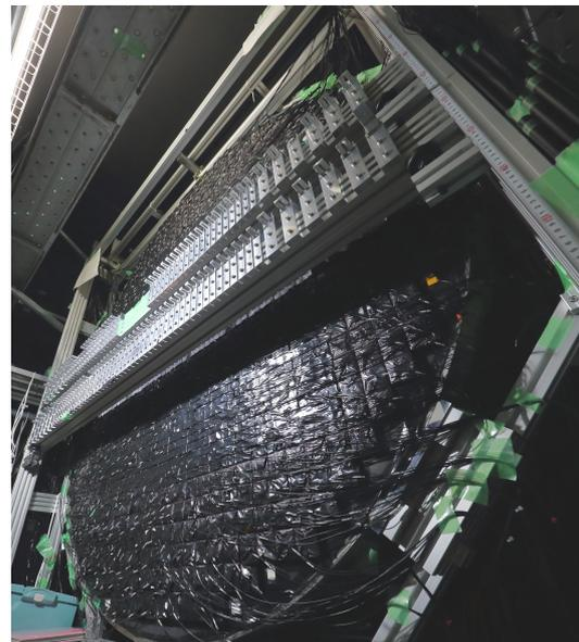
図 3.8 MPPC 接着中の上流から見た CsI カロリメータ。フレーム上に横一列に並んでいるのが、MPPC を接着するための治具である。
