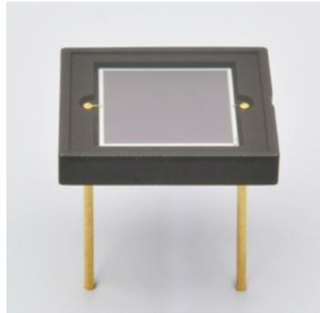
図 3.1 CsI カロリメータ上流に取り付けた MPPC (S13360-6050CS) [22]。
