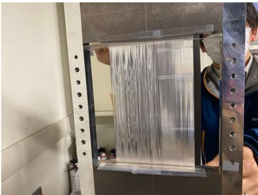
図 4.10: 一部のファイバーを固定した様子. 右側 1/3 程度が固定されたファイバーであり, 真っ直ぐ張られている.
