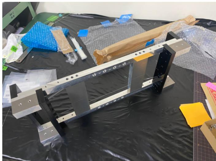
図4.1: BFT-Dのフレームを組み立てた様子。
