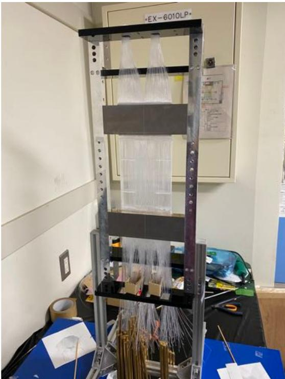
図 4.14: BFT-D X' 層のファイバーを錘をかけながら固定している様子.
