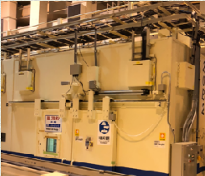
BL20B2 中尺BL Bending 視野 300mm-5mm 分解能 10\mu\text{m} 大視野CT
