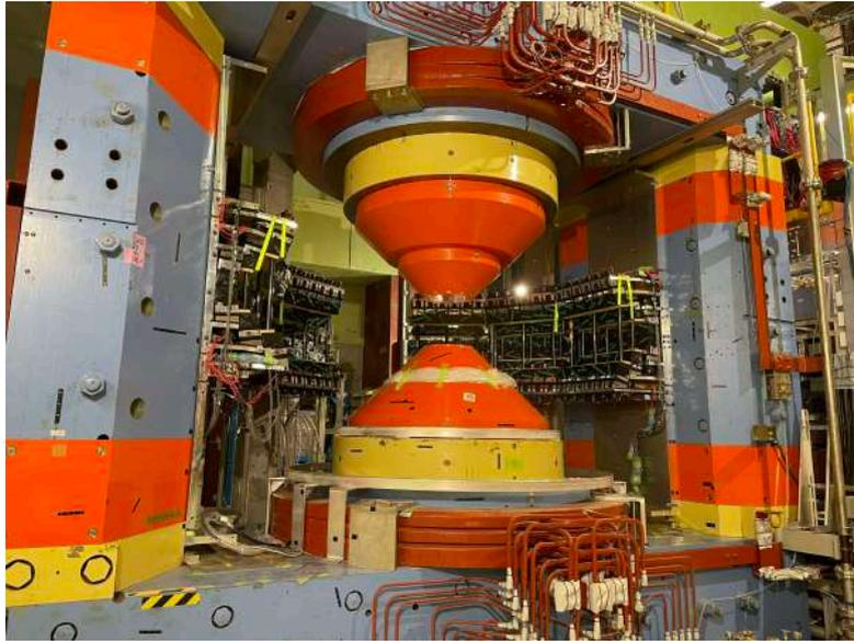
図 1.3: FM 双極電磁石。現在は、J-PARC E16 実験用の仕様になっており、E50 実験では磁極の変更を行う計画である。
