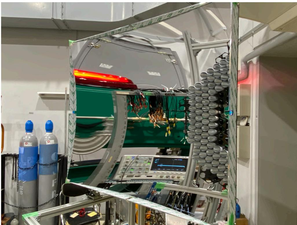
図 2.5: 曲率半径  $R = 300$  cm、焦点距離  $f = 150$  cm の球面反射鏡。実機ではこれを 20 枚繋げて全体の反射鏡を形成する。
