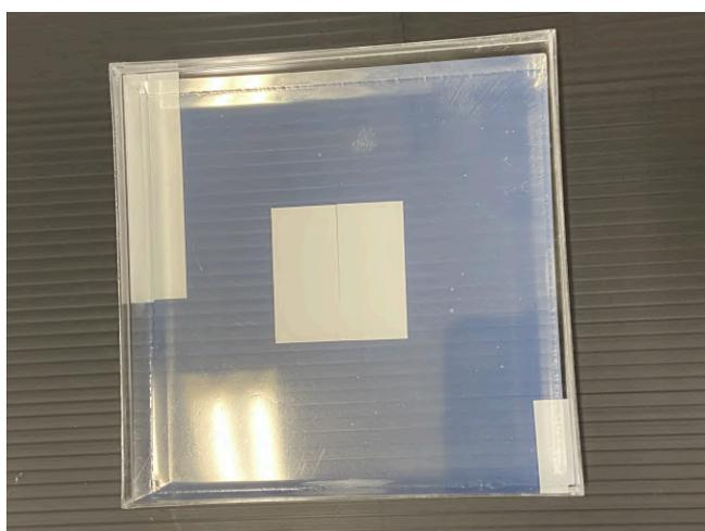
図 2.3: 実機の RICH 検出器で用いる  $n = 1.04$  (透過長 50 mm) のエアロゲル。
