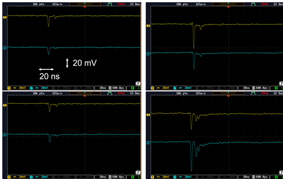
図 4.3: 各ストリップ幅の信号の波形、オシロスコープのスケールは全ての図で同じである。(上左)ストリップ幅 1.15 mm、(上右)ストリップ幅 1.35 mm、(下左)ストリップ幅 1.60 mm、(下右)ストリップ幅 4 mm。
