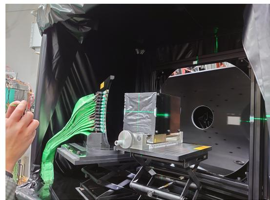
図 3.4: Beam-RICH 検出器の遮光シートの内部
