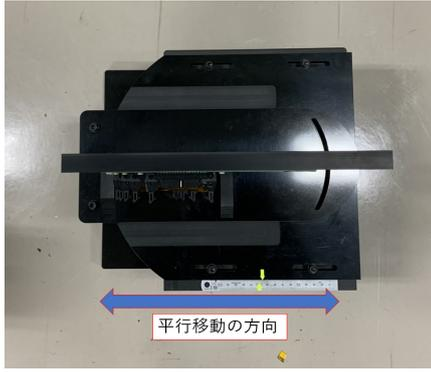
図 2.42: 基準位置 (回転角  $0^\circ$ ) にある光検出面。図中の矢印の方向に平行移動が可能である。
