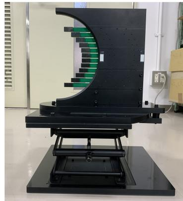
図 2.41:  $K^-$  ビーム 5 GeV/c 用の MPPC アレイの配置をした光検出面
