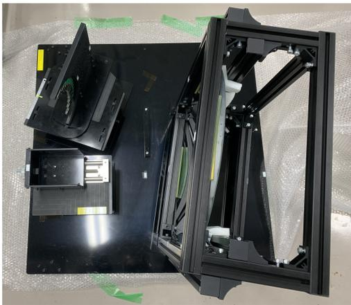
図 2.35: 球面鏡回転角  $10^\circ$  での光学系の配置
