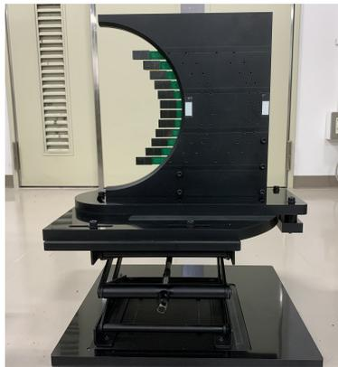
図 2.40: 陽電子ビーム 1 GeV/c 用の MPPC アレイの配置をした光検出面
