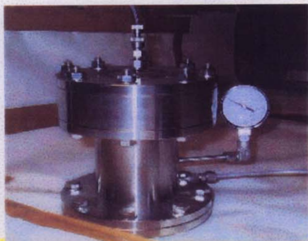
^{252}\text{Cf} チェンバー（核分裂生成物を ガスジェットに乗せる）
